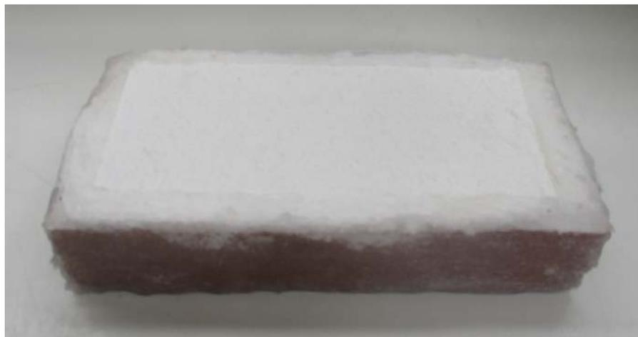
**Figura 2. Provino al termine della procedura di sigillatura laterale.**
